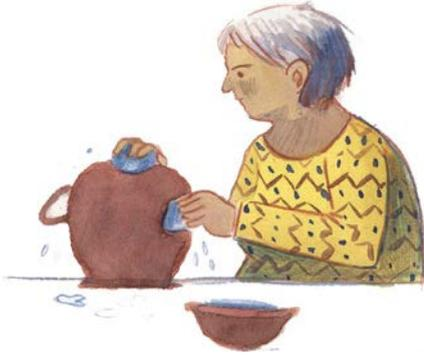
Una vez que la pieza está callaneada, se procede a lustrarla con un poco de agua y una piedra de río por dentro y por fuera. Esto permite terminar con todas las imperfecciones que hayan podido quedar. Luego la pieza se deja orear nuevamente para proceder con el pulido final.
